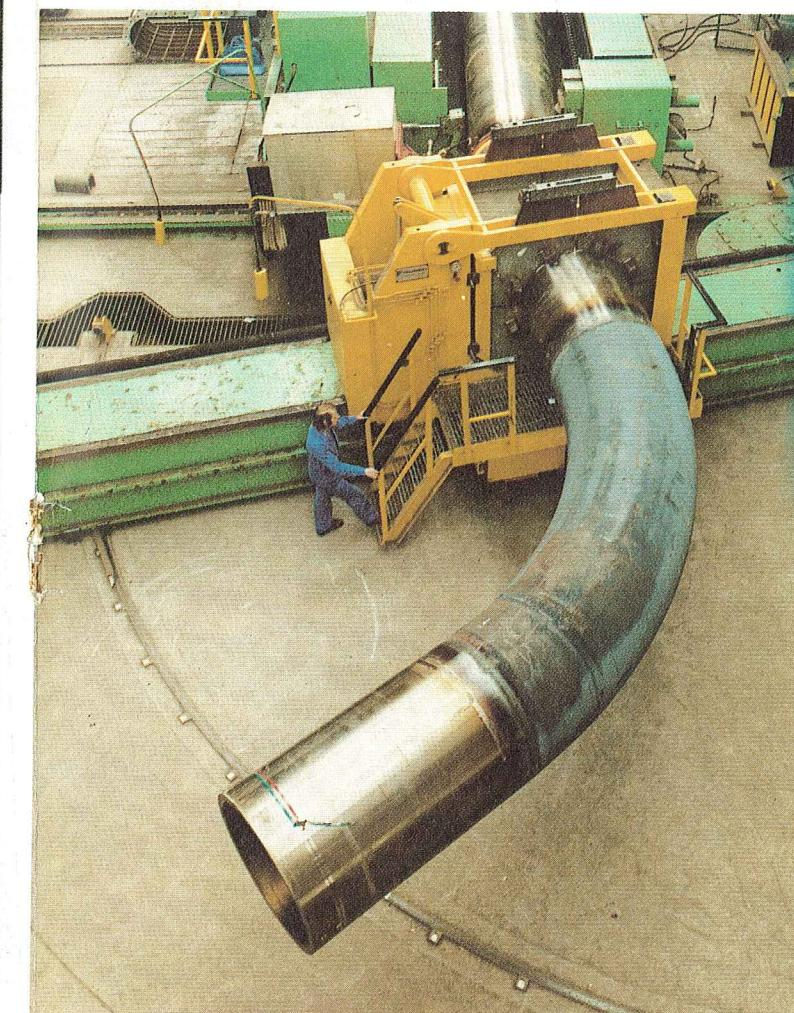
Machine à cintrer les grosses tuyauteries (diam. max. 1 422 mm)
