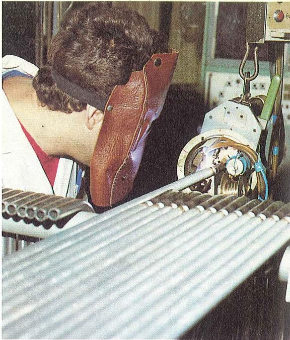
Soudure orbitale de petits tubes d'échangeurs
