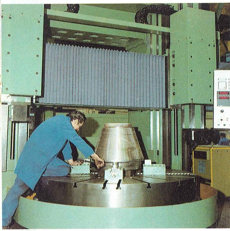
Tour vertical à commande numérique - (diamètre 2,3 m - hauteur 1,6 m)
