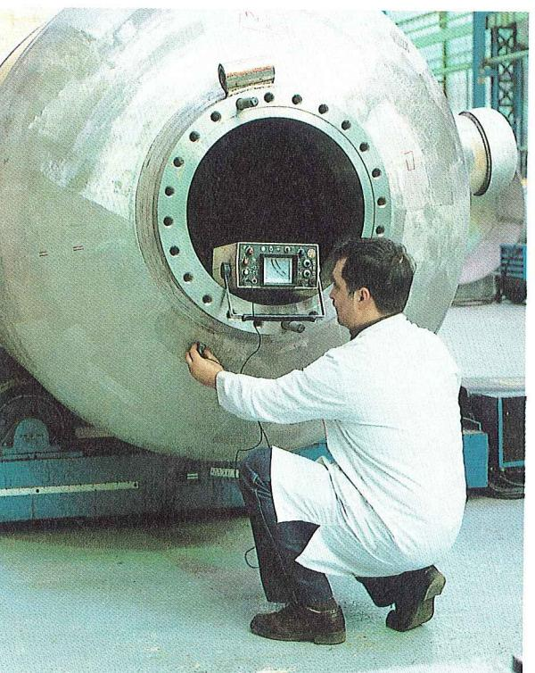
Contrôle de soudure par ultra-sons
