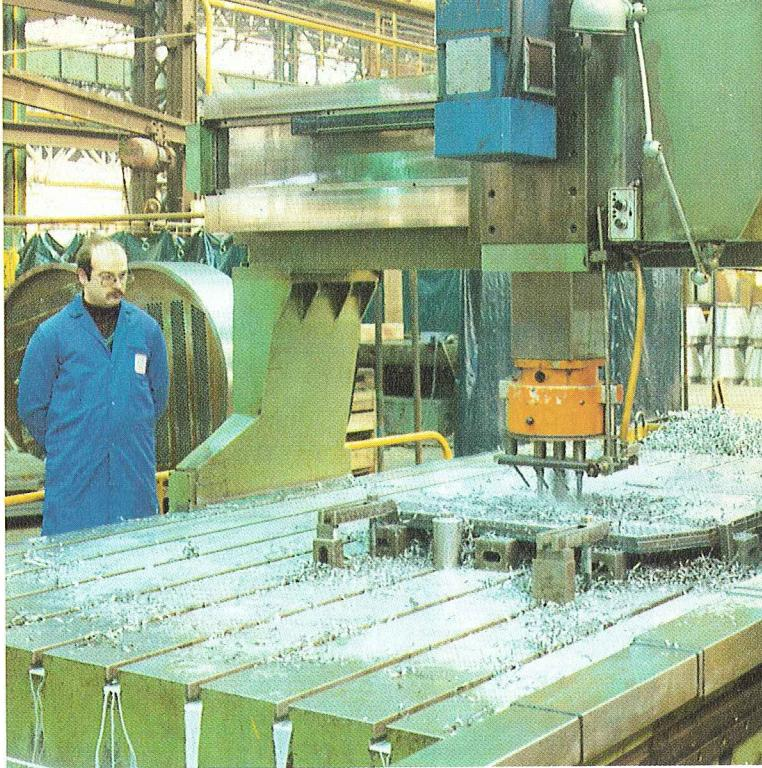
Perceuse à perçage à commande numérique.
